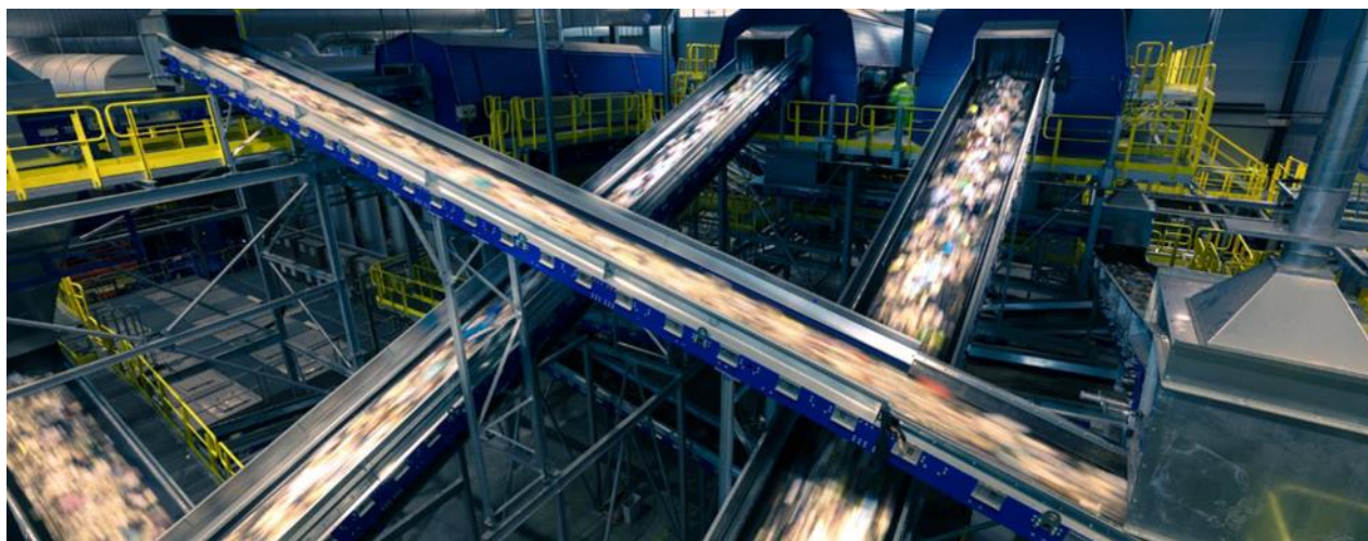
Figure 12 BOSS-anläggningen i Brista där plast, matavfall och metaller sorteras ut för återvinnas eller gå till biogasproduktion.
